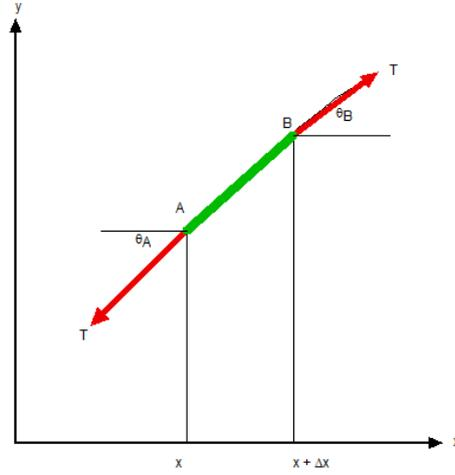
**Fig.B2** Tension  $T_s$  on the string
