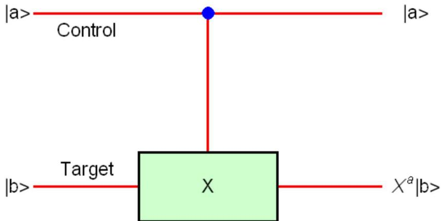
**Fig.3** Controlled  $X$ -gate.  $|a\rangle$ : control.  $|b\rangle$ : target.  $X^a|b\rangle$ .
